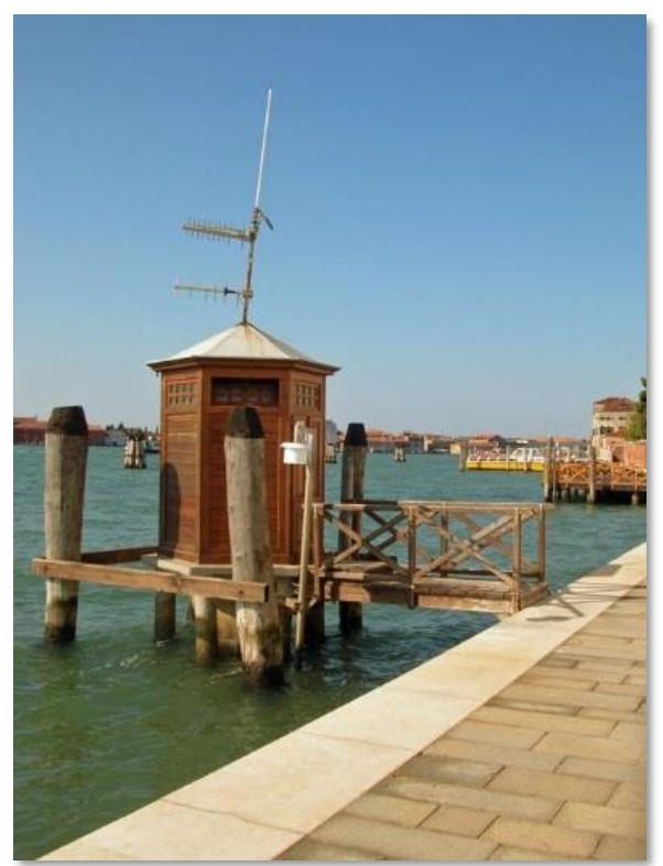
Float gauge at Punta della Salute (Venezia, Italy). Source: ISPRA
